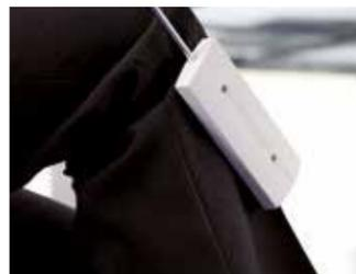
**Geradstichplatten-Sensor** – Sicher ist sicher! Bei angebrachter Geradstichplatte kann keine Nadel unbeabsichtigt auf die Stichplatte auftreffen.
