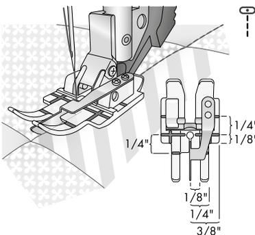
Der Klarsichtfuß für Nähen in der Naht bietet perfekte Sicht und wurde entwickelt, damit Sie auf der Quiltobenseite perfekte Quiltnähte nähen können. Die Führung gleitet leicht über die Naht und sorgt für ein optimales Nähen „in der Naht“.
