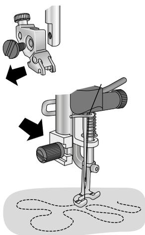
Der offene Freihandsprungfuß eignet sich perfekt zum Freihandnähen und -quiltten. Dank großer Öffnung bietet er freie Sicht auf das Nähgut. Die Sprungfunktion sorgt dafür, dass sich der Stoff beim Nähen nicht mit der Nadel nach oben und unten bewegt. Der Stoff wird beim Freihandnähen und -quiltten von Hand geführt.
